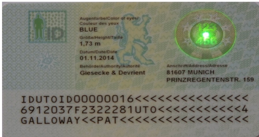
Figure 18 – Carte à LED, révélant le code CAN par illuminations
